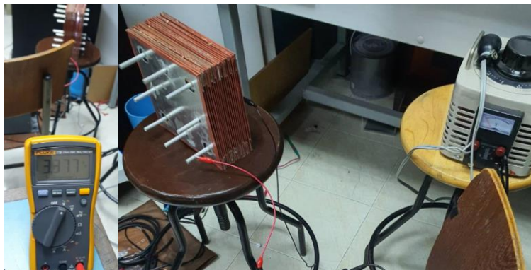
รูปที่ 6 ทดสอบแรงดันแผ่นประจุแบบขนาน
