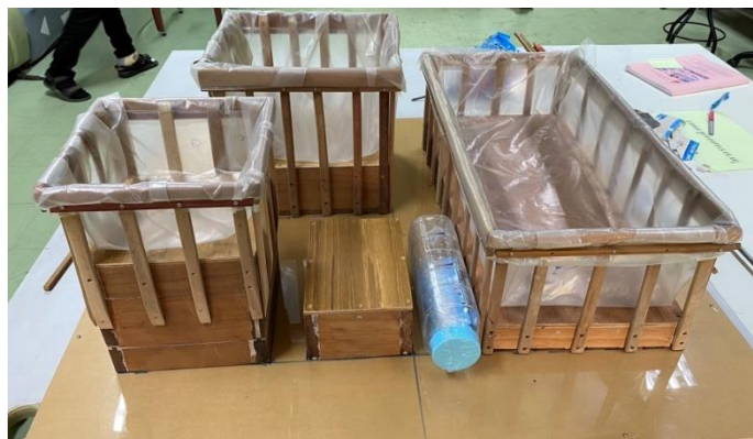
รูปที่ 11 โครงสร้างชุดสาริระบบหมุนเวียนน้ำในกระชังบ่อสำหรับการเลี้ยงปลา
