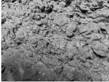
รูปที่ 1 คอนกรีตผสมเส้นใยเหล็ก
