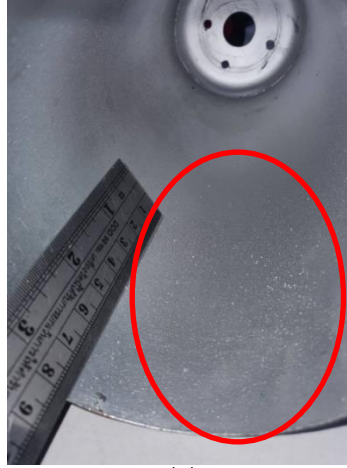
รูปที่ 9 อนุภาคควันบุหรี่ที่ติดกับแผ่นประจุขั้วบวก
