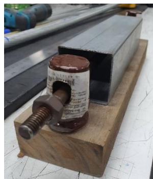
รูปที่ 7 ต้นแบบขั้วประจุแบบแกนกลาง
