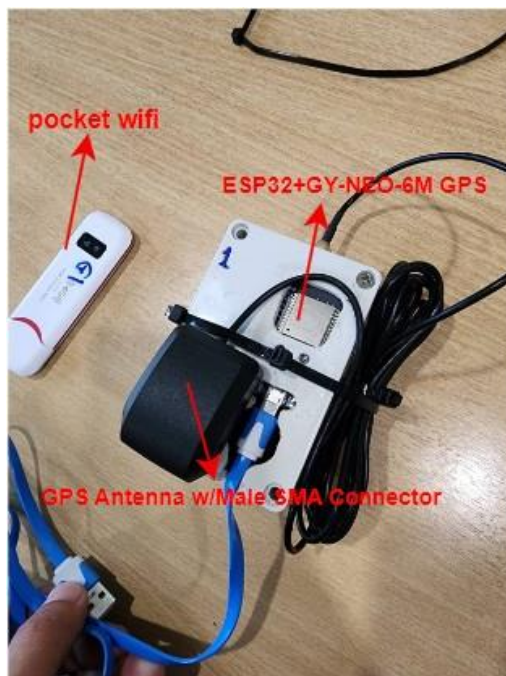
รูปที่ 3 อุปกรณ์ติดตามยานพาหนะ และการติดตั้งอุปกรณ์ภายในยานพาหนะขนส่งสินค้า
