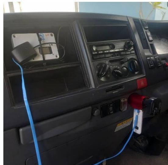
รูปที่ 3 อุปกรณ์ติดตามยานพาหนะ และการติดตั้งอุปกรณ์ภายในยานพาหนะขนส่งสินค้า
